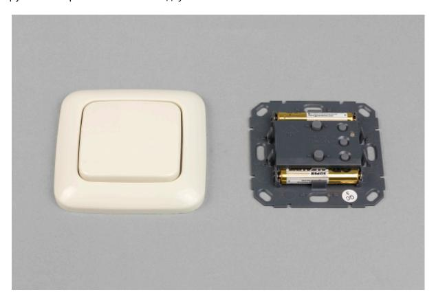
Под клавишей находятся светодиодный индикатор, кнопки включения в сеть, исключения и управления ассоциациями. При необходимости выключатель можно запрограммировать и на выполнение более сложных действий, чем просто управление светом. Однако кодовые комбинации «два раза вверх, один вниз» всетаки не очень удобны на практике.
