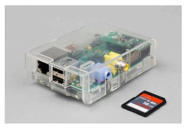
Дополнительно используется плата расширения RaZberry для связи с сетью Z-Wave, а для программного обеспечения присутствует карта памяти SD. Плата компьютера установлена в пластиковый корпус, для питания используется внешний блок с кабелем на microUSB.
