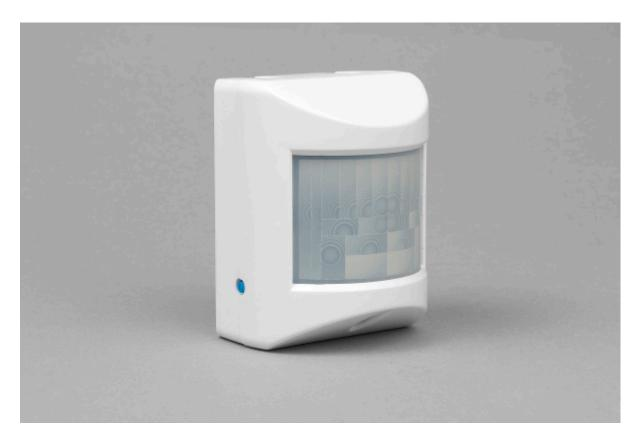
Питание осуществляется от трех батарей ААА. Единственная кнопка на корпусе используется для включения в сеть/исключения из сети, включения и выключения. Чувствительность и другие параметры датчика можно настроить через контроллер Z-Wave. Есть возможность питания устройства от внешнего источника.
