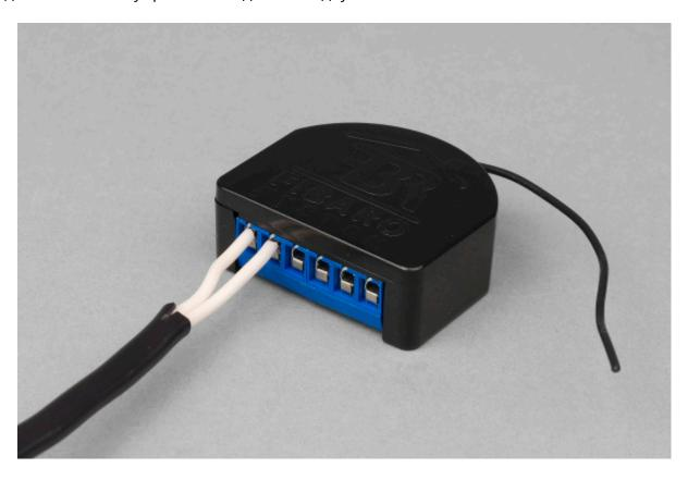
На корпусе также есть скрытая кнопка для включения в сеть или удаления, а антенна представлена небольшим отрезком провода. Сам блок очень компактный (37×42×18 мм) и может без труда уместиться в стандартный подрозетник.
