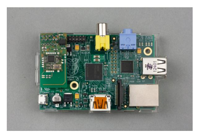
Компьютер имеет невысокую стоимость, неплохой набор интерфейсов (включая USB и сетевой порт), поддержку внешних модулей и совместим с Linux. Его производительности вполне достаточно для решения задач обслуживания сети Z-Wave и реализации необходимых алгоритмов управления.
