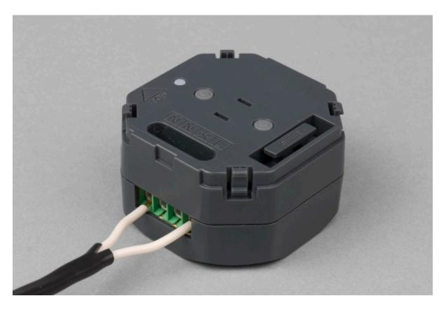
В комплекте с блоком идет стандартная накладка и клавиша, так что внешне отличить «умный» выключатель от обычного может быть непросто.
