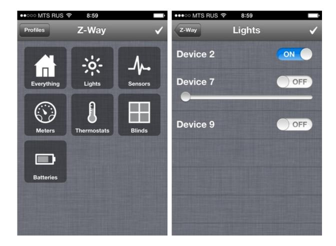
Кроме работы через браузер, компания разработала утилиту для мобильных устройств на базе iOS. Текущая версия доступна в официальном магазине приложений App Store. Работа в утилите ведется только с физическими устройствами, поддержки схем, скриптов и других расширенных функций в настоящий момент нет.
